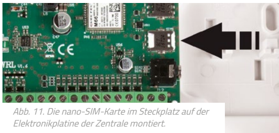
Abb. 10. Montage der nano-SIM-Karte.
